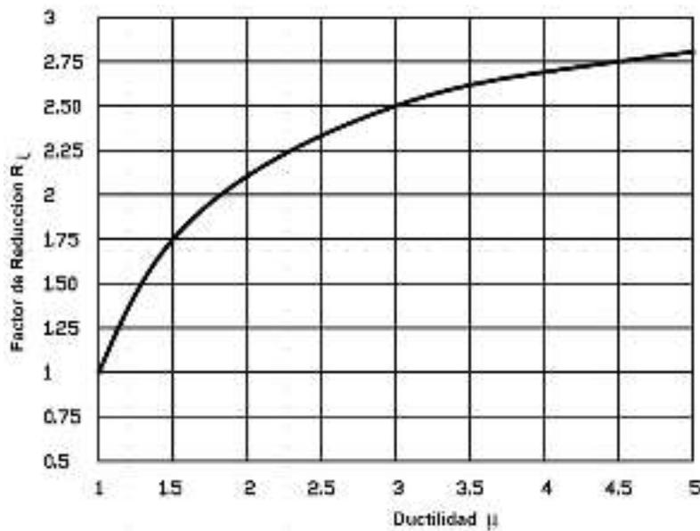
Figura 12: Factor de Reducción de la Demanda Sísmica  $R_\xi$
