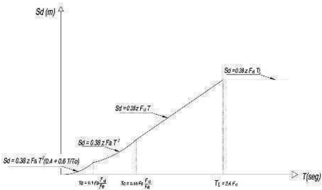
Figura 4 : Espectro sísmico elástico de desplazamientos para diseño
