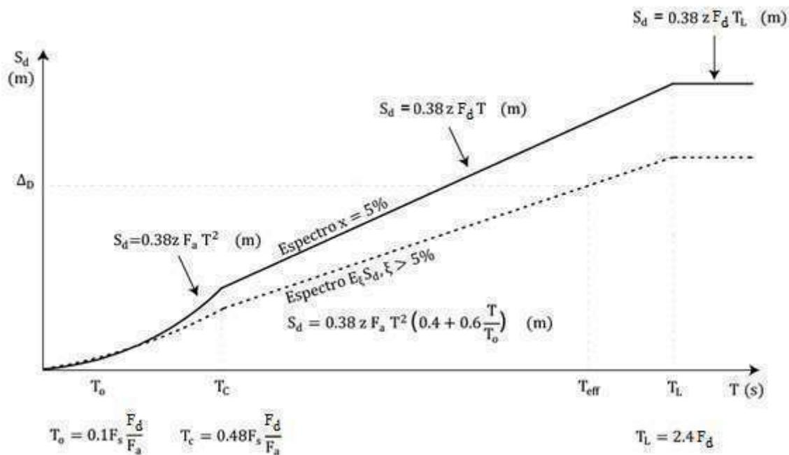
Figura 13 : Periodo efectivo de sistema equivalente de un grado de libertad
