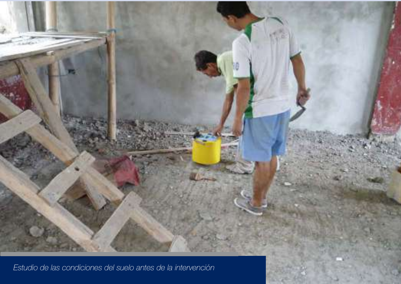
El densímetro nuclear fue una de las herramientas utilizadas para comprobar la densidad del suelo
