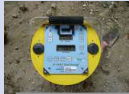
El densímetro nuclear fue una de las herramientas utilizadas para comprobar la densidad del suelo
