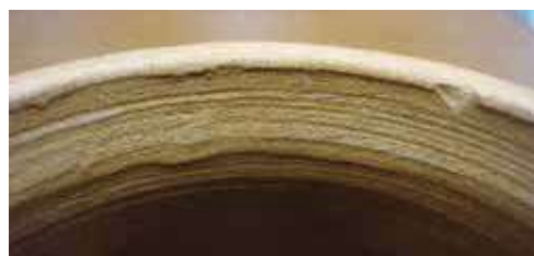
Vista en detalle de huellas de torneado en sentido horizontal y paralelas
