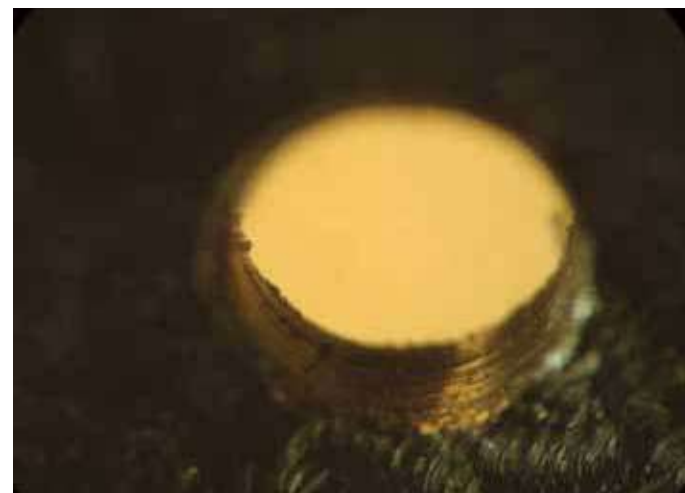
Perforación simétrica con taladro. Vista macroscópica de estrías en sentido horizontal
