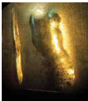
Repujado contemporáneo con cincel, vista macroscópica de superficie delineada y filos angulares
